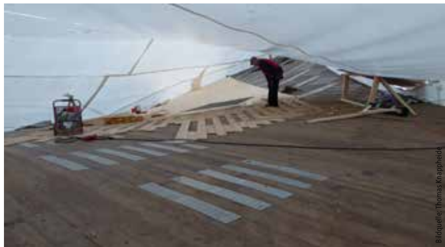
Nachdem zunächst kleine Einzelzelte zum Einsatz kamen, wurde schließlich eine große Folie, wie ein zweites Segel als wetterfeste Einhausung gespannt.
