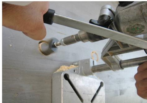
Üblich sind Bohrkernentnahmen mit einem Durchmesser von 35 mm und Bohrkronen mit einem Außendurchmesser von 50 mm.
