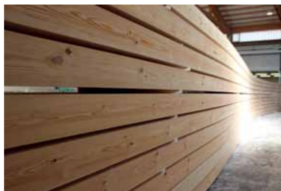
33m lange Satteldachbinder aus Kiefern-Brettschichtholz.
