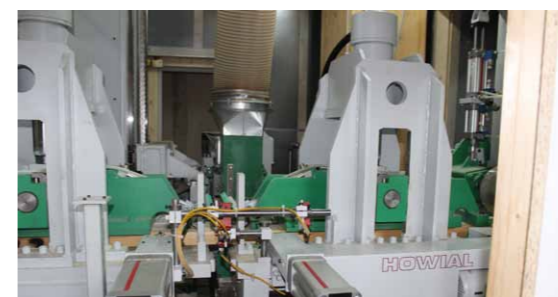
Im Kompaktkeilzinkenautomat werden die Lamellen in derselben Position gefräst, beleimt und gepresst.
