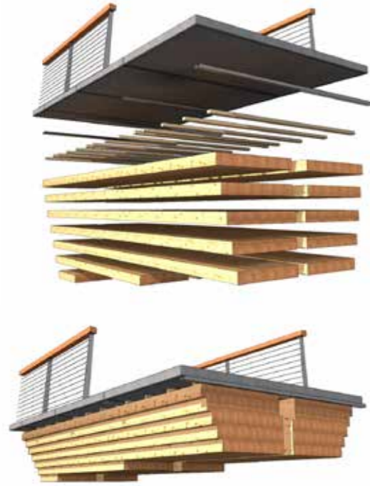
Schematische Zeichnungen vom Aufbau der Blockträger
