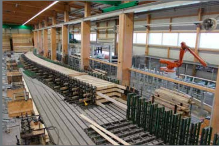
Nach dem ersten Schritt, der Längsverleimung der Lamellen, beginnt die Verleimung zu Brettschichtholz, hier mit Biegung in eine axiale Richtung
