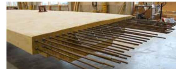
Für die Remstalbrücken wurden 78 Betonrippenstähle mit 2,30 und 3,00 m Länge jeweils 1,20 m weit in den blockverklebten Brettschichtholz-Träger mit Epoxidharz eingeklebt.
